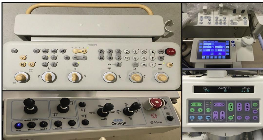
**Figura 1.** Paneles de control representativos de 4 fabricantes de fluoroscopios diferentes. Obsérvese la falta de estandarización de los controles clave. En el sentido de las agujas del reloj desde la parte superior izquierda: Philips (Ámsterdam, Países Bajos), Siemens Healthineers (Erlangen, Alemania), GE Healthcare (Chicago, Illinois), Omega Medical Imaging (Sanford, Florida, EE.UU.).
